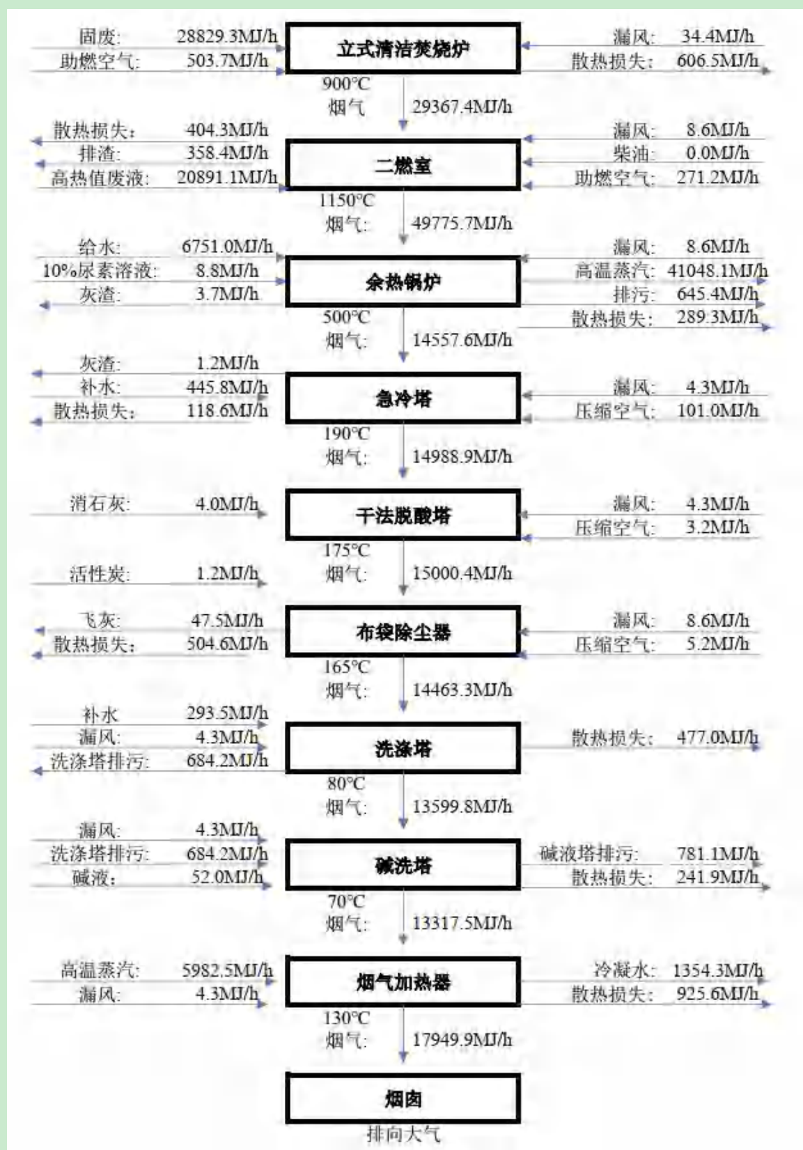
图 4.5-5 焚烧系统热平衡图
